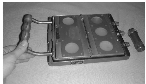
Рис. 1. Кассетное устройство «Медуза» для проведения экспериментов по синтезу биологических молекул в условиях полета орбитальных станций и спутников.
