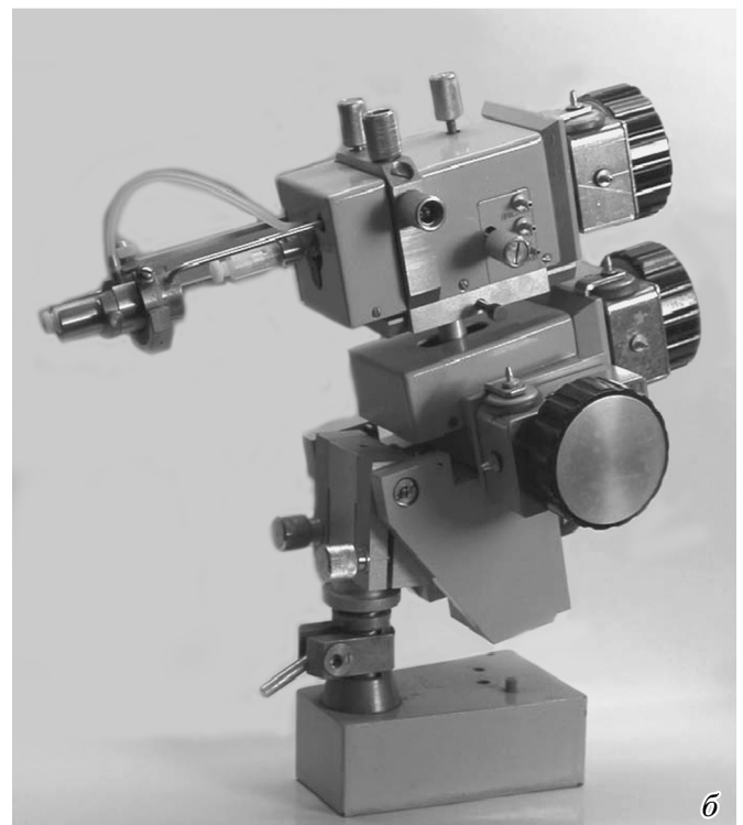
Рис. 2. Схема пересадки ядер ( а ) и микроманипулятор для пересадки ядер ( б ).
